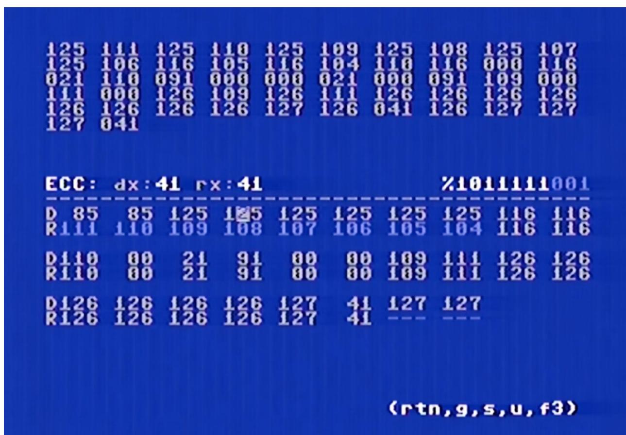
Fig.3 Modtaget DSC-besked. Øverst de modtagne bit (7 databit + 3 paritetsbit) på decimal form, og nederst korrigeren for FEC<sup>\*4</sup>-forskydning samt beregnet ECC<sup>\*5</sup>.
